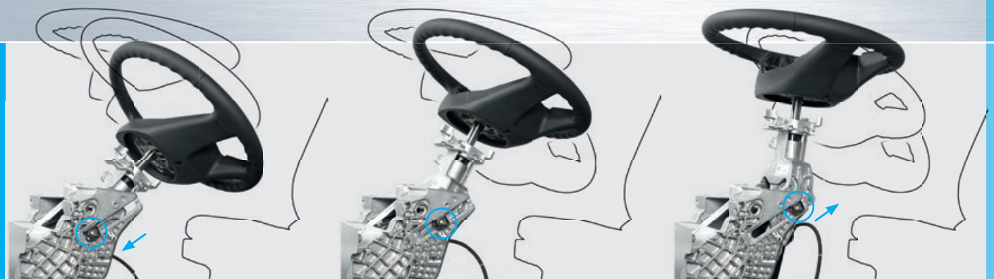
Komfort-Lenksäule Großes Verstellfeld pneumatisch betätigt
