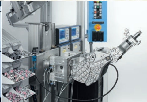
Endmontage von Lenksäulen
