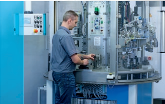
Vormontage von Lenksäulenkomponenten
