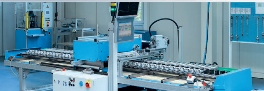
Serienbegleitender Endprüfplatz mit Kamerasystem für modulare Lenkwischenwellen
