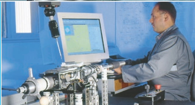
3D-Messtechnik zur Produktvalidierung
